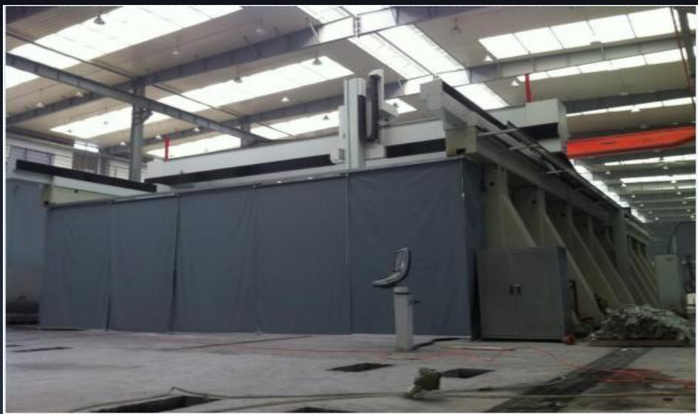
大型建筑3D打印机 长150米，宽10米，高6.6
