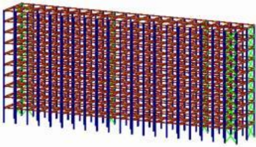
图 17 钢框架支撑案例 X方向增加两道支撑后三维模型
