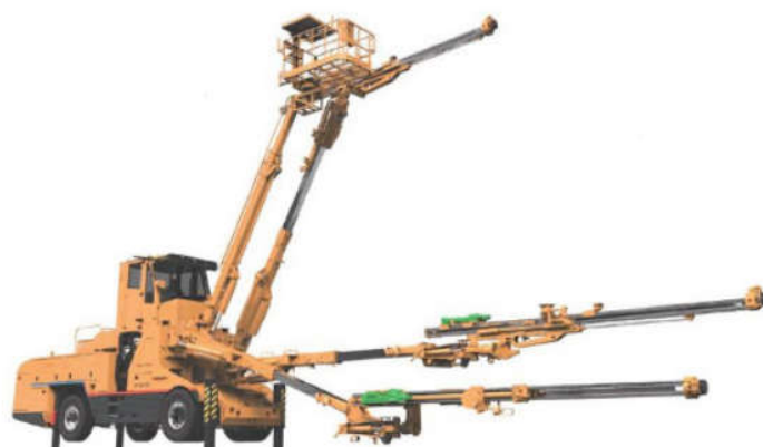
图 2.1 ZYS113 型全电脑三臂凿岩台车示意图
