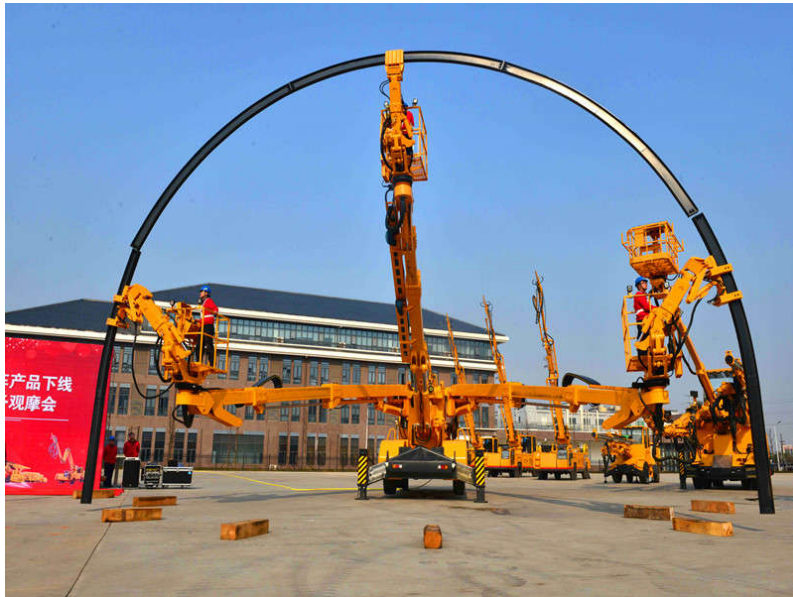
图 2.2 SCDZ133 智能型隧道多功能作业台车
