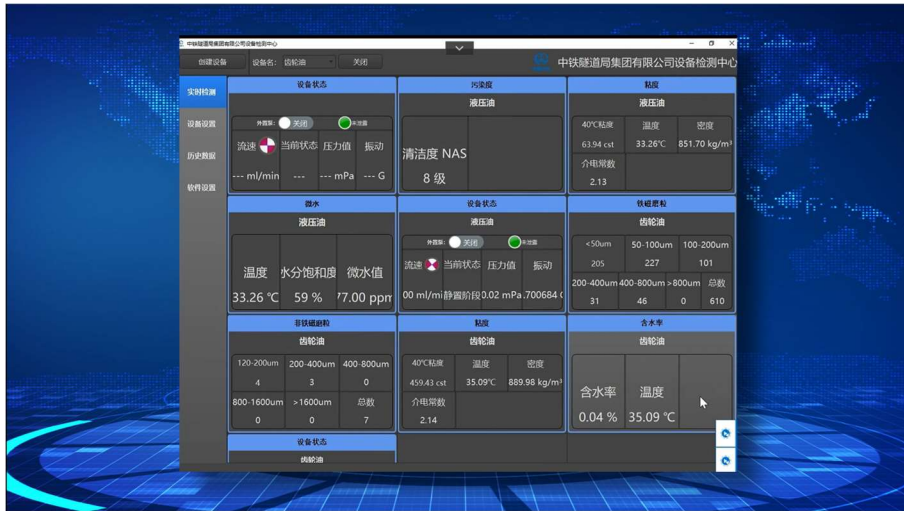
图 3.5-2TBM 智能在线监测系统
